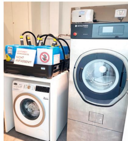
Waschmaschine mit Dosieranlage
